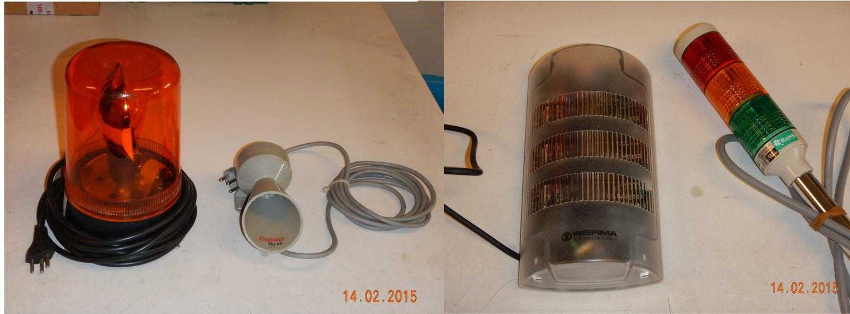
Drehleuchte für optische und Horn für akustische Alarmierung bei Überschreitung eines festlegten Alarmwertes
