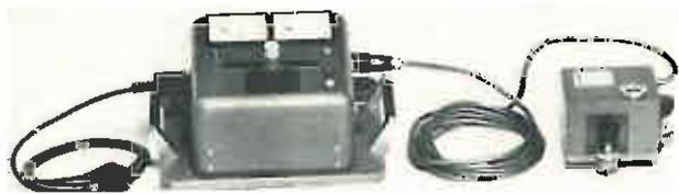
Bild 8. Messstation ZEB/DGAMs 5 und Anzeigegerät zur Ablesung des Spitzenwertes  $V_R$ .
