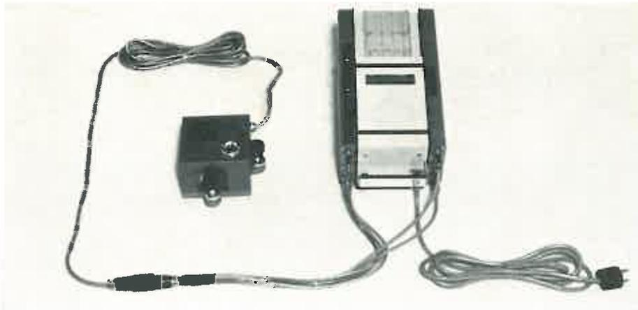
Bild 3. Messstation ZEB/DGL 5 zur Registrierung der Einzelkomponenten  $V_x$ ,  $V_y$  und  $V_z$ .
