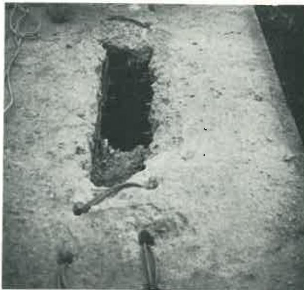
Bild 4. Doppelt eingebrachte Sprengschnur.
